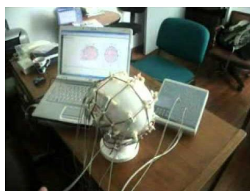
Figura 5. Electroencefalograma de 32 canales interfaz a PC.
