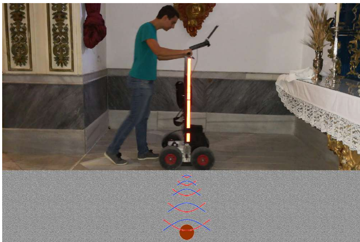
Fig. 4. Esquema básico del funcionamiento del GPR.
