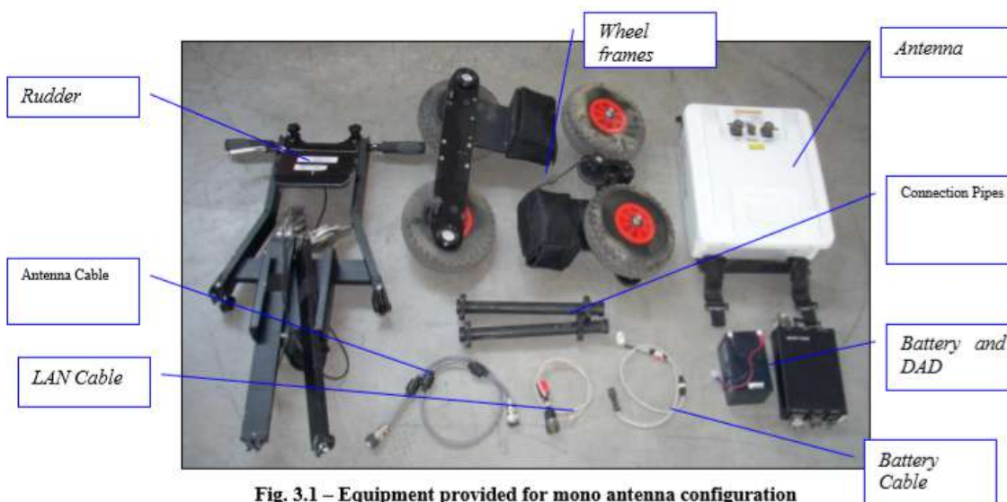
Fig. 5. GPR RIS Hi-Mod 1A bifrecuencia y componentes básicos.
