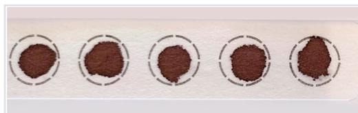
**Si la gota recogida ha sido insuficiente para impregnar las dos caras de un círculo, no se debe volver a utilizar ese círculo,** pues se produciría una estratificación de la muestra que impide su correcto análisis.
