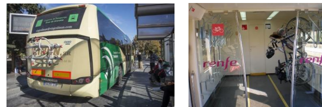
Ilustración 66: Ejemplos ortobicietas instalados en buses CTM Área de Granada y Renfe. Fuente: Elaboración propia
