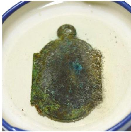
**Fig. 18 y 19.** Reacciones químicas de los baños con ácido acético
