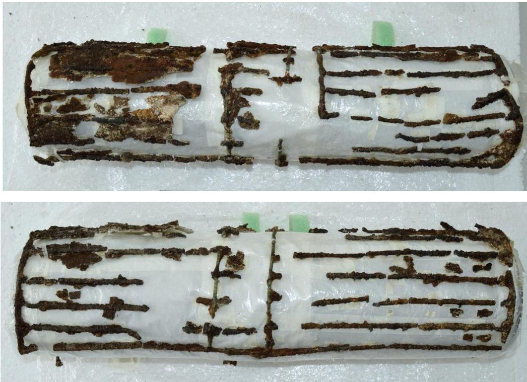
**Fig. 35 y 36.** Resultado final de la reconstrucción de la férula
