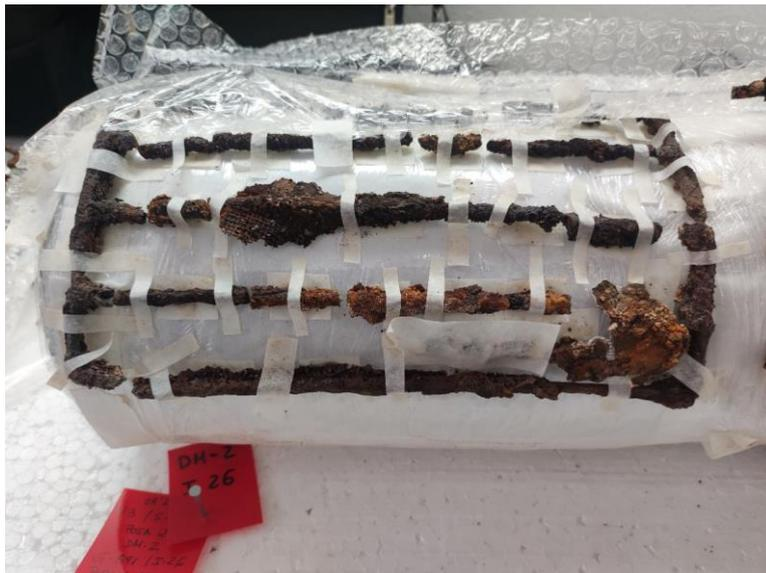
**Fig. 28.** Detalle de la reconstrucción de la zona baja de la férula
