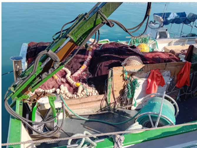
Zona de cubierta para circular. Las redes pueden ocupar espacios de tránsito si los accesos no están claramente delimitados.
