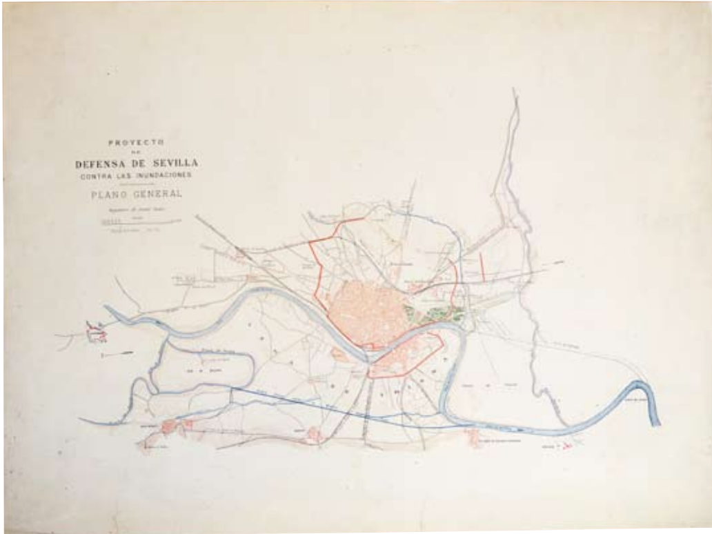
Plano general del Proyecto de Defensa de Sevilla contra las inundaciones, por el ingeniero Javier Sanz, 1900. En este plano quedan recogidas, en esbozo, muchas de las grandes obras hidráulicas que paulatinamente se irían acometiendo a lo largo del siglo XX y que condicionarían de manera determinante la expansión urbana de Sevilla. Centro Geográfico del Ejército, Madrid.
