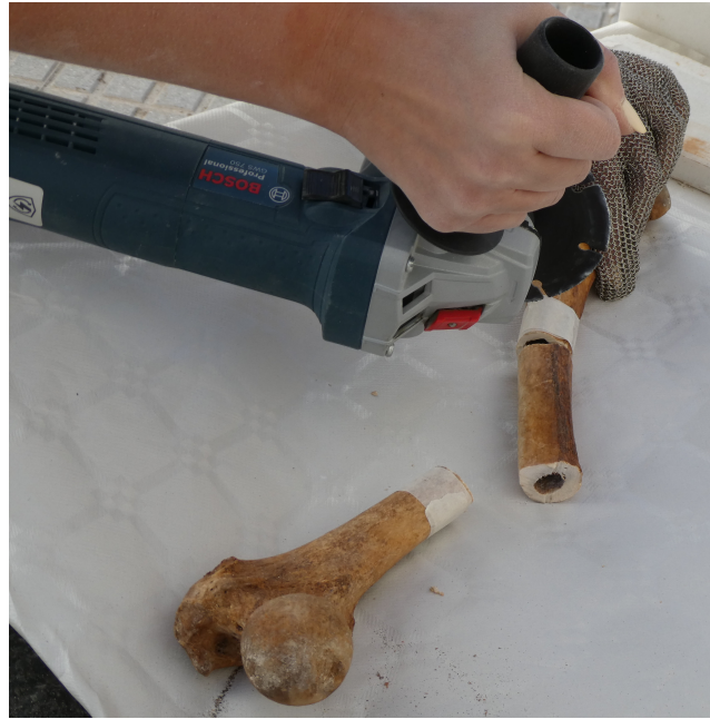
Fig. 1. Corte de muestra de 10 cm con amoladora.
