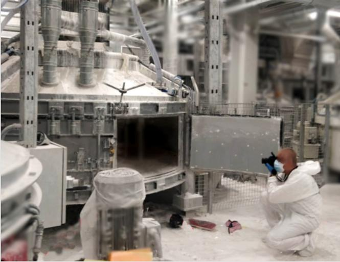
Cuatro trabajadores accedieron al interior de una mezcladora industrial para limpiarla sin aplicar las medidas de consignación. El sistema de bloqueo estaba anulado, y la máquina permanecía conectada. Sin supervisión adecuada, comenzaron las tareas hasta que, de forma repentina, la mezcladora se puso en marcha. Tres operarios lograron salir con lesiones, pero uno quedó atrapado en el mecanismo y falleció a consecuencia de las heridas.
