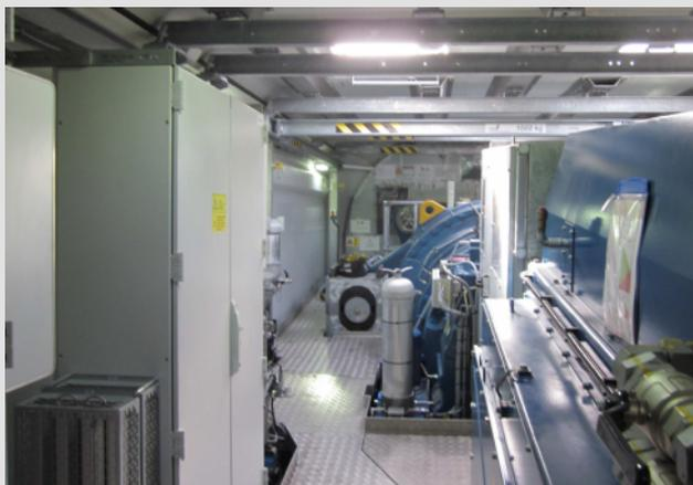
Durante labores de mantenimiento en un aerogenerador, un operario accedió sin autorización a una zona de riesgo tras desbloquear el rotor, sin volver a bloquearlo. Aprovechó que la trampilla presentaba una vulnerabilidad y la forzó sin utilizar la llave ni informar al equipo. El rotor, libre, giró por acción del viento y atrapó al trabajador entre el disco de bloqueo y la estructura. El resultado fue mortal.
